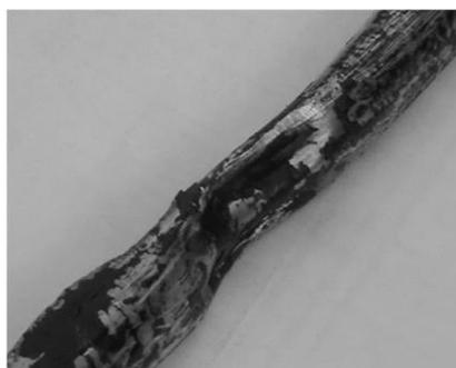
**Рисунок 6.9 – Результат удара молнии на кабель**
